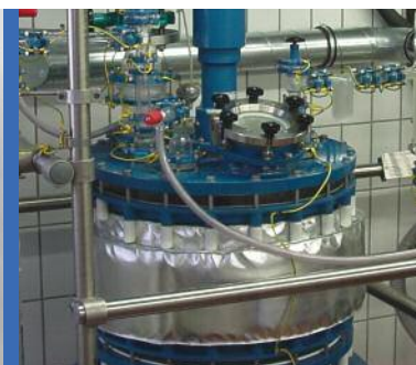
Reactor with removable insulation Reaktor mit demontierbarer Isolation
