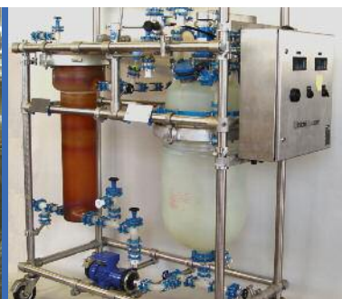
UV-reactor with brown stained glass UV Reaktor mit brüniertem Glas
